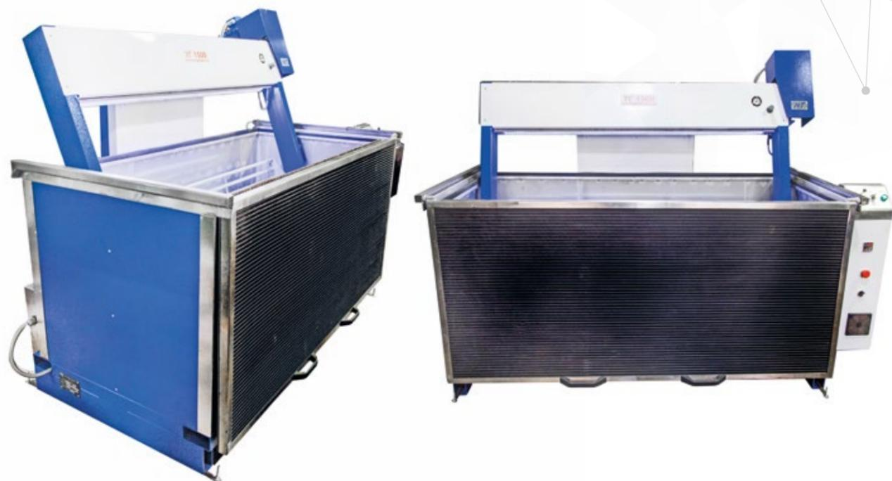
Установка для гидравлических испытаний серии УГ предназначена для тестирования как самих блоков, так и головок блока цилиндров. Принцип работы оборудования заключается в проверке узлов на герметичность с применением сжатого воздуха в водной среде. Герметичность – одна из важнейших характеристик, обуславливающих исправную работу двигателя автомобиля. Основной причиной появления дефектов в головке блока цилиндров является разгерметизация рубашки охлаждения из-за высоких нагрузок и температуры.
