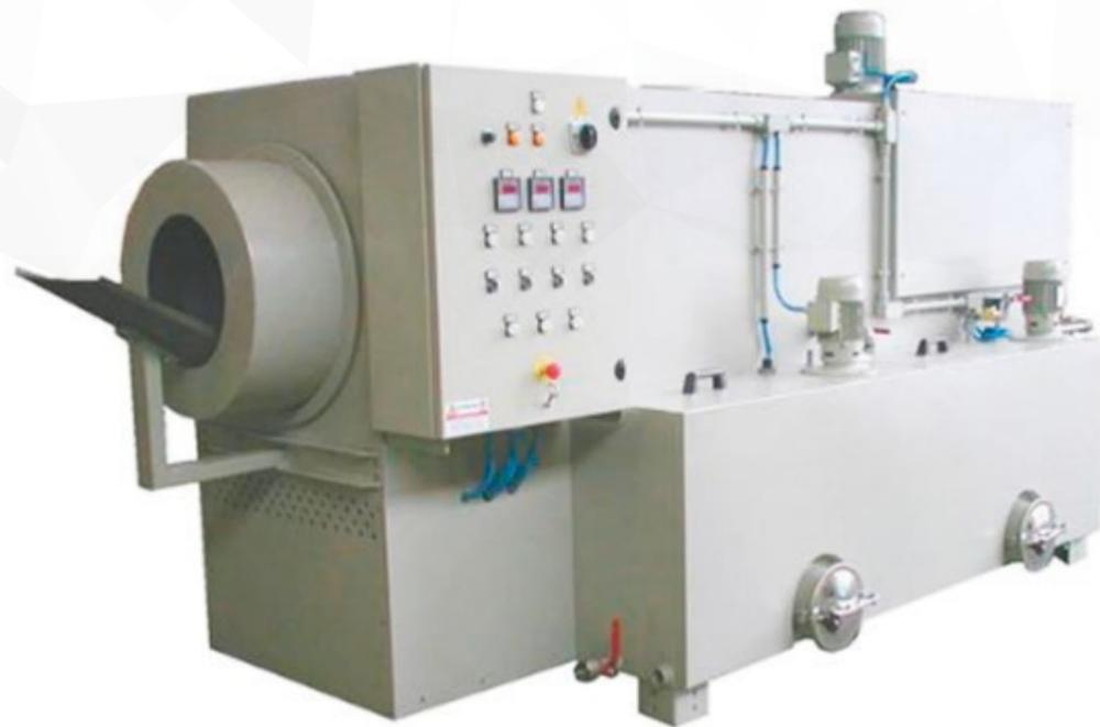
Шнековая моечная машина предназначена для очистки больших партий мелких деталей с простой геометрией. Они идеально подходят для предприятий производящих метизную продукцию, крепежные компоненты, фитинги, вентили и подобные изделия. Установка способна в поточном режиме обезжировать, удалять механические загрязнения, ополаскивать и сушить детали.
